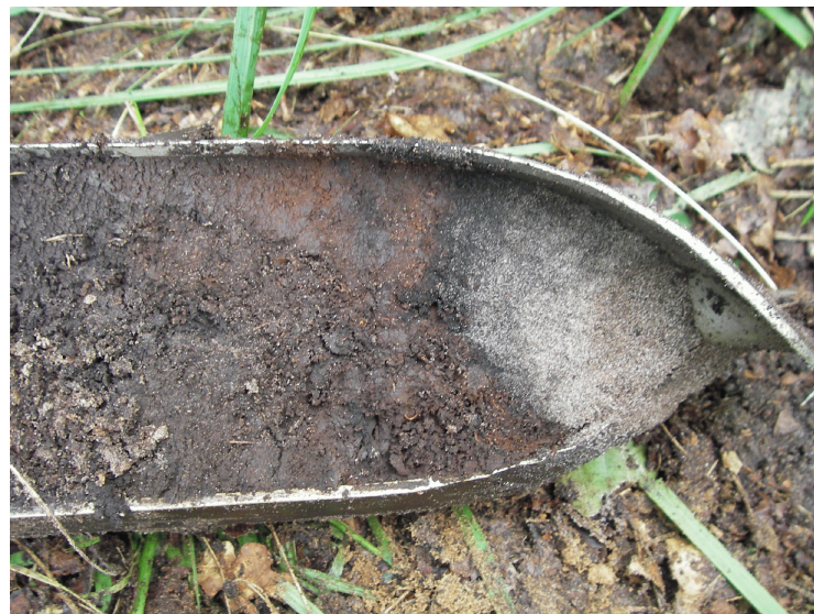
Figuur 7.4: Afgesneden boorkop van boring 508 op de overgang van zand naar veen. Rechts is de uitspoelingslaag zichtbaar van de podzolbodem. Links is de bovenliggende veenlaag zichtbaar. Op de grens is een centimeter veraard veen aanwezig.
